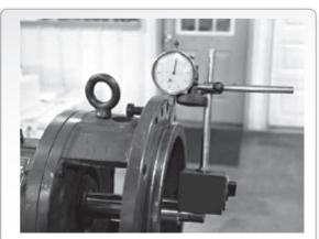
FIGURE 23 ADAPTER FACE RUNOUT CHECK
