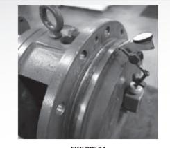
FIGURE 24 STUFFING BOX COVER RUNOUT CHECK
