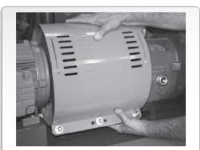
FIGURE A-5 COUPLING GUARD ADJUSTING THE LENGTH
