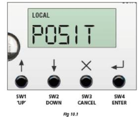
**NOTE: SETTINGS CAN ONLY BE CHANGED WITH THE ACTUATOR SET TO LOCAL OPERATION.**
