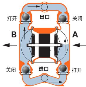
图2当受压隔膜A达到排出冲程限值时，空气阀将压缩空气导向隔膜B的背面。压缩空气将隔膜B推离中心体，而将隔膜A拉向中心体。隔膜B开始进行排出冲程。由于泵内管道和液体腔室内的液压力增大，隔膜B将进口阀球顶回阀座。同样的这些液压力将出口阀球抬高阀座，而反方向的出口阀球返回阀座，迫使液体流向泵的出口。隔膜A向泵的中心体移动，从而在液体腔A内形成真空。大气压将液体压入泵的进口管道。进口阀球从阀座被顶起，使液体被泵入液体腔。
