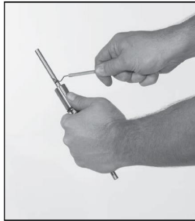
步骤 8 使用O型圈拾取器，从导向阀另一端轻轻拆下O型圈。检查是否出现磨损、裂纹或其他损伤。如有损坏，请更换导向阀组件。
