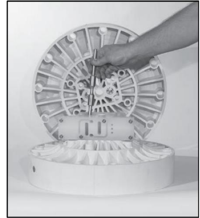
步骤 9 从中心体拆下气阀阀芯。检查阀芯和O型圈是否磨损。如有必要，请更换。
