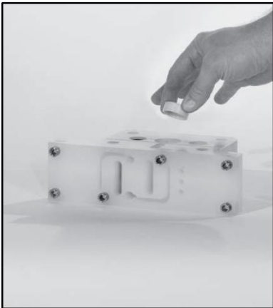
步骤 10 拆下并检查（2个）轴衬套。如有必要，请更换。
